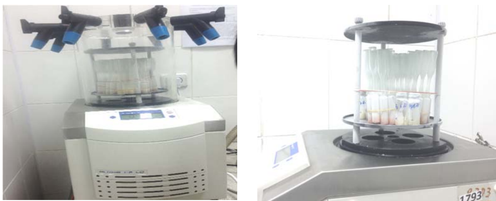
2-сурет. ALPHA 1-4 LSC аппаратында люминесценттік бактерияларды лиофилдеу барысы
